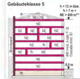
Abbildung 5: Zuordnung des geplanten Gebäudes gemäß BayBO (Auszug Grafik Brandschutzmaßweis BayBO - Checkliste Feuer Trutz)
