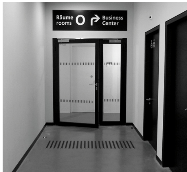
Große und kontrastreiche Beschilderung in einem Messegebäude
