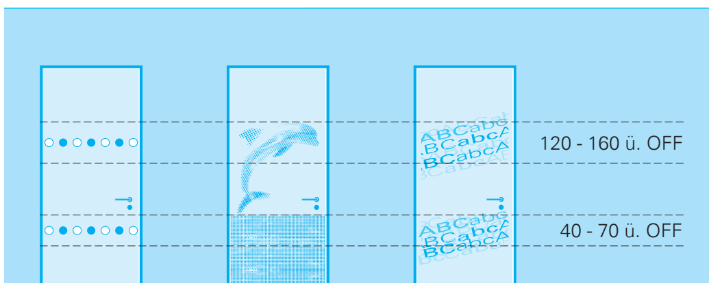
Abb. 25 Beispiele für Sicherheitsmarkierungen an Glastüren, z. B. links: helle und dunkle Kreise oder Quadrate in Augen- und Kniehöhe. Mitte und rechts: Bildmotiv als Sicherheitsmarkierung: Die Normvorgabe ist erfüllt, wenn in Augen- und in Kniehöhe in ausreichender Breite Wechselkontraste entstehen. M 1:50
